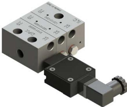
Diese Steuerung besteht aus einem Schalter, der in einem kleinen Block eingeschlossen ist. Der Kolben, der sich in seinem Funktionssitz verschiebt, öffnet und schließt den Kontakt des Schalters.
